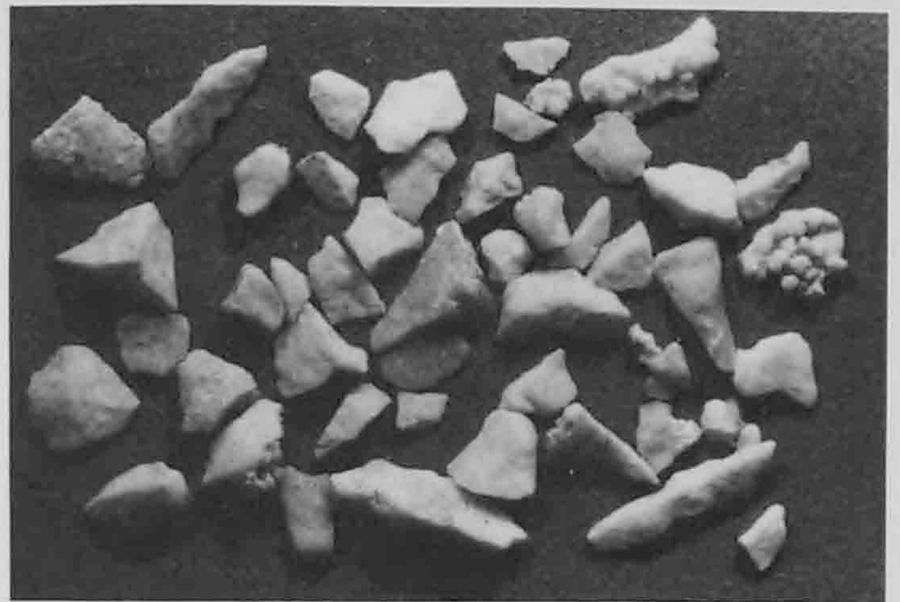
Fig. 91. Vue au binoculaire des sables grossiers (0.5-2mm) de l'éch. SII-17 (c. 5). On remarque l'aspect très anguleux des fragments calcaires et l'absence de fragments biogènes.
