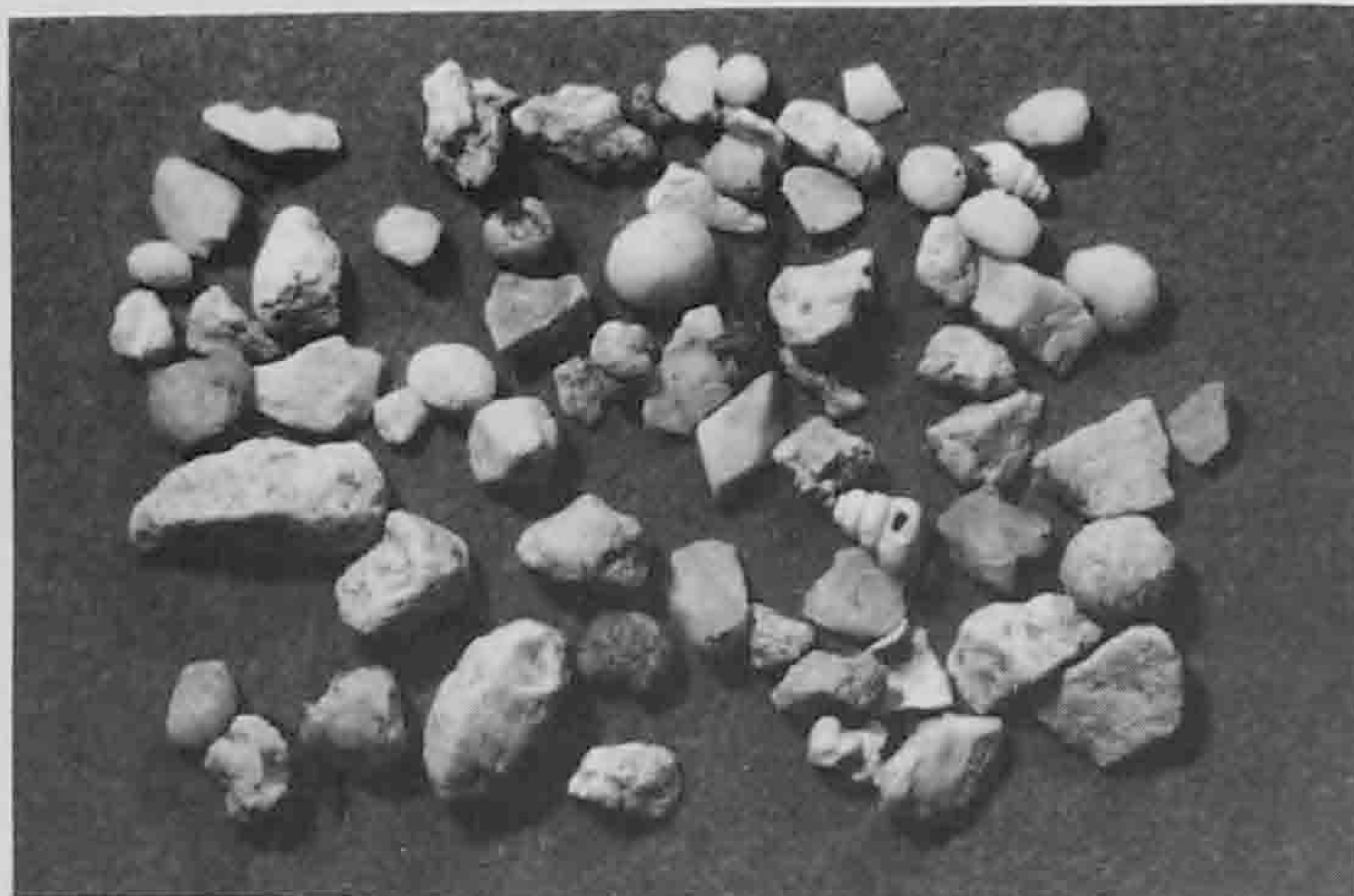
Fig. 93. Vue au binoculaire des sables grossiers (0.5-2mm) de l'éch. SI-2 (base c. 2). Noter l'aspect corrodé des fragments calcaires, les granules et les mollusques qui témoignent de l'activité biologique.
