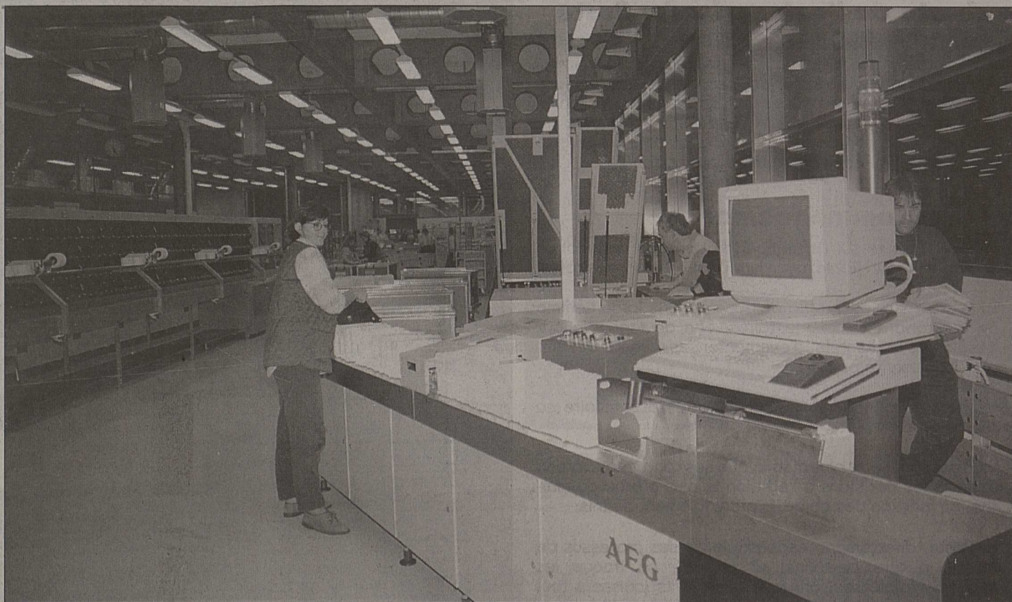
Au centre de tri de Sion, la prestation de chaque lecteur automatique se distingue par 30 000 envois à l'heure.
