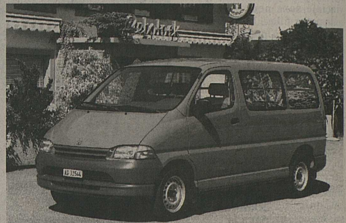
Le nouveau Toyota Hiace se distingue notamment de ses prédécesseurs par son museau proéminent très plaisant, qui résulte de l'abandon de la cabine avancée.
