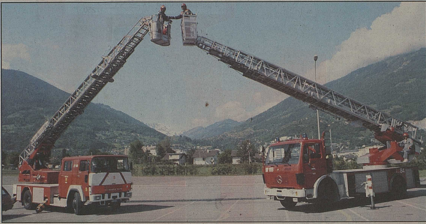
Les auto-échelles: celle de Monthey et le camion Ciba (à droite). Hauteur maximale d'intervention: près de 37 mètres.
