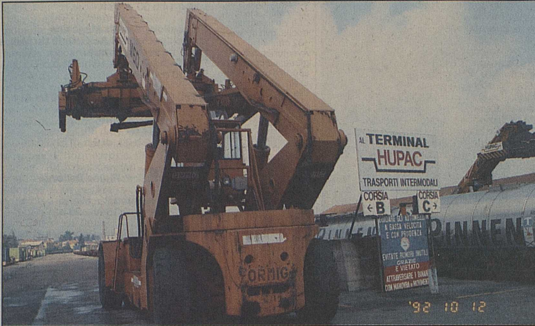
Au premier terminal de ferroustage de Busto Arsizio: ces tracteurs peuvent transborder plus de 35 tonnes.
