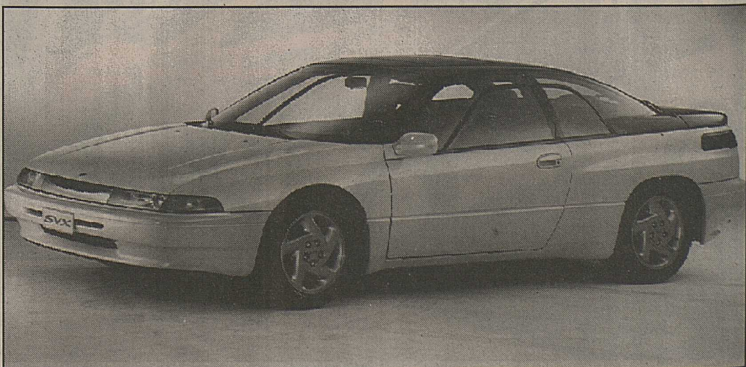
Les moteurs grandissent. C'est aussi le cas chez Subaru, avec la SVX. Sous son esthétique étonnante, ce coupé sportif cache en effet un 6-cylindres boxer - disposition chère à la marque - d'une cylindrée de 3,3 litres. Les 230 ch qu'il fournit passent au sol via une traction intégrale. L'habitacle, luxueusement traité, peut accueillir quatre occupants. (Première européenne)
