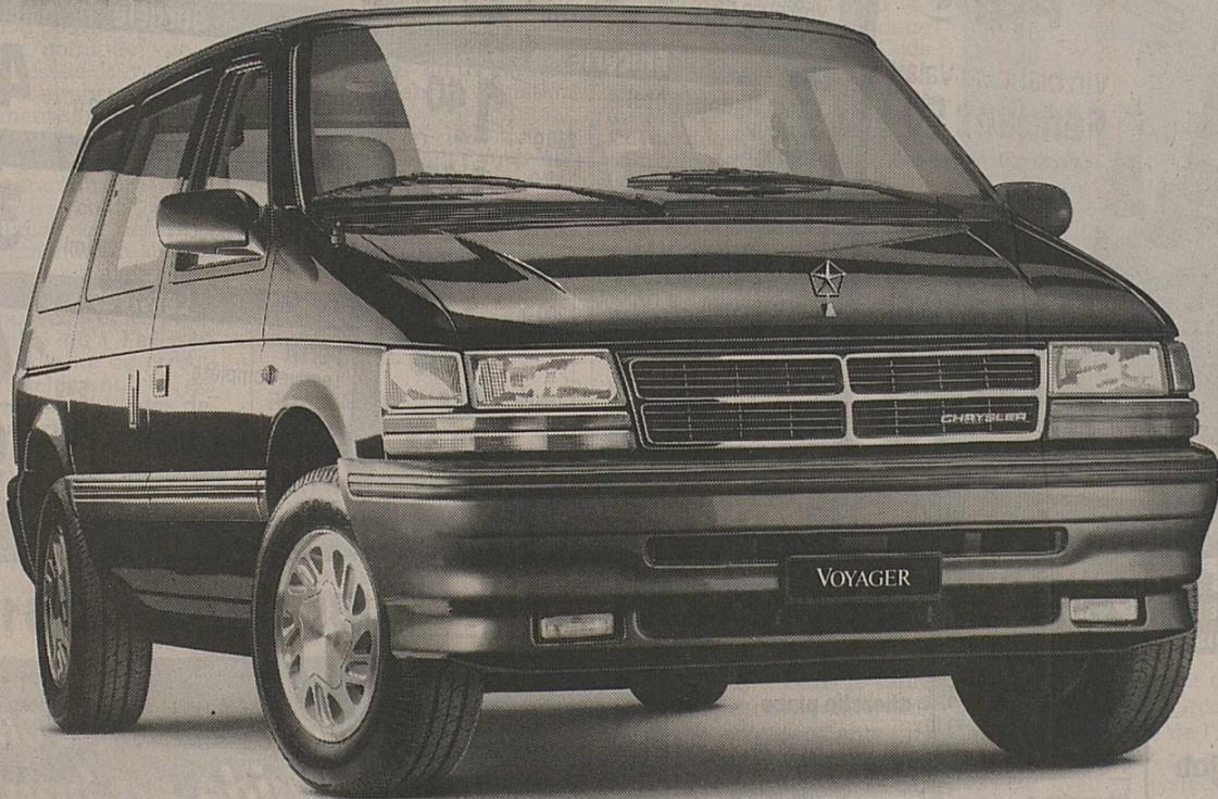
La technique: moteur V6 de 3,3 l (110 kW/150 CV-DIN), traction avant.
