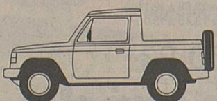
en tissu (3 portes, 4 places). Doté d'un moteur Turbodiesel 2,5 l à intercooler, 70 kW (95 ch) et 235 Nm/2000 tr/mn. Ou d'un moteur à essence 2,6 l. Maniable, polyvalent et d'une valeur stable: le Metal Top (3 portes, 4 places). Doté d'un moteur à essence de 2,6 l,
