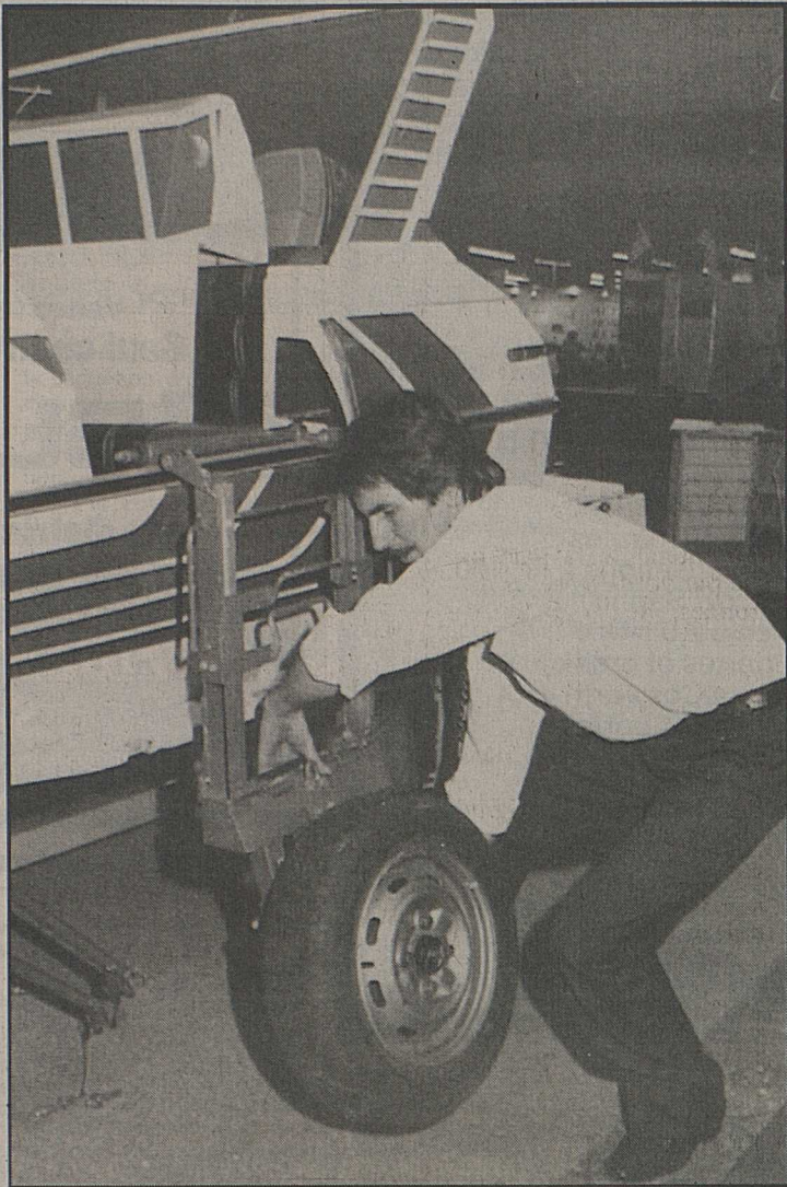
Parmi les mille trouvailles exposées, ce bateau homologué sur l'eau et sur la route. Ainsi que le montre son inventeur, M. Mathias Burlet, de Zoug, un ingénieux système de roues escamotables permet à cet engin aussi bien de voguer sur les flots que de filer sur l'autoroute comme une remorque ordinaire.
