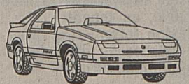
GS Turbo 2 Fr. 32.500.- 2,2 l Turbo avec intercooler (130 kW/177 CV-DIN) boîte à 5 vitesses
