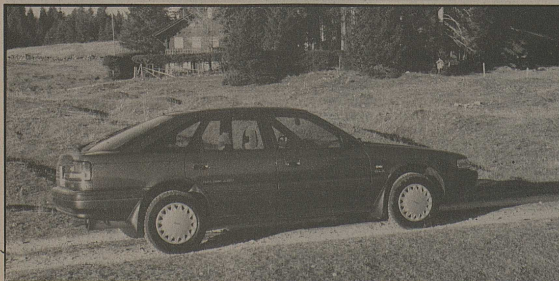
La 626 4WD reçoit une transmission inédite comprenant notamment deux viscosoupleurs.
