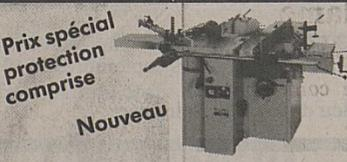
Pour scier, travailler   la loupie, d foncer, raboter tirer d' paisseur, percer et mortaiser, tenonner.
