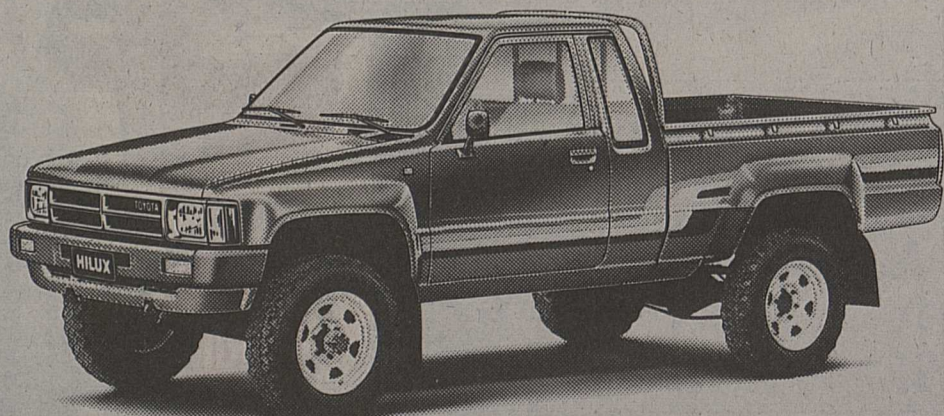
Toyota Hilux 4WD X-TRA CAB: une camionnette originale, mais combien sérieuse; 2 places, 4 cylindres à essence, 2237 cm 3 , 69 kW (94 ch) DIN, boîte à 5 vitesses et réducteur spécial tous terrains, 1080 kg de charge utile, fr. 24 500.-. (Il existe 2 Hilux de base, livrables en 7 versions.)
