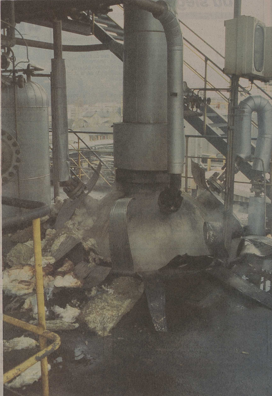
La surchauffe du réacteur a entraîné une évaporation de 90 kilos de liquide, ainsi que la formation d'un nuage blanc.
