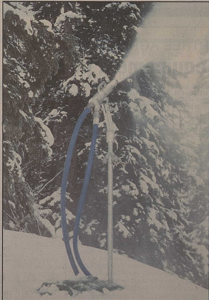
Le canon à neige. L'air comprimé pulvérise l'eau en gouttelettes microscopiques. Au contact de l'air froid ambiant, l'eau se cristallise et devient neige.
