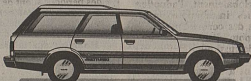
Subaru 1.8 Super-Station Turbo 4WDmatic, traction permanente 4x4 à commande électronique, boîte automatique à 4 rapports, 120 CV DIN, servo-direction, suspension indépendante électropneumatique à compensation de niveau automatique et réglage en hauteur, Fr. 30 600.-.
