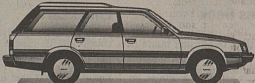
Subaru 1.8 Super-Station 4WD, traction permanente 4x4 à différentiel central, 2x5 vitesses, 98 CV DIN, servo-direction, Fr. 26 000.-.
