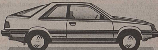
Subaru 1.8 Coupé Turbo 4WDmatic, traction permanente 4x4 à différentiel central, 5 vitesses, 120 CV DIN, servo-direction, Fr. 29 550.-.
