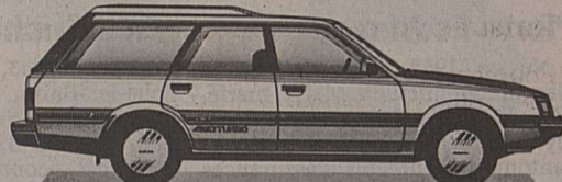
Subaru 1.8 Super-Station Turbo 4WD, traction permanente 4x4 à différentiel central, 2x5 vitesses, 120 CV DIN, servo-direction, suspension indépendante électropneumatique à compensation de niveau automatique et réglage en hauteur, Fr. 29 000.-.
