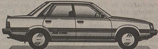
Subaru 1.8 Sedan Turbo 4WD, traction permanente 4x4 à différentiel central, 2x5 vitesses, 120 CV DIN, direction assistée, suspension indépendante électropneumatique à compensation de niveau automatique et réglage en hauteur, Fr. 27 700.-.
