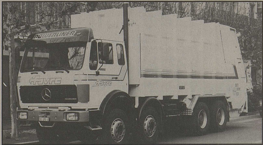
Un véritable mastodonte spécialement équipé pour la collecte de déchets encombrants. Dans la trémie peuvent être déversés 2 mètres cubes de déchets avant qu'il ne soit nécessaire d'enclencher la phase de compression. (Photo Georges-André Cretton)
