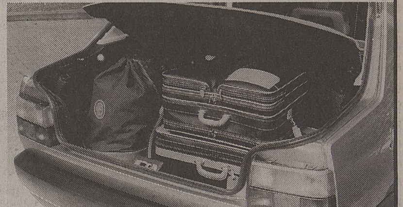
L'exemple type d'une esthétique fonctionnelle: masqué par les lignes raffinées de la partie arrière de la Croma, le coffre vous offre un volume de 500 litres qui passera même à 1400 litres en rabattant les deux sièges arrière.
