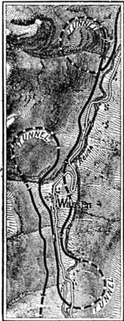
Fig. 71. — Tunnels en spirale près de Wassen. Echelle : 1/50 000.
