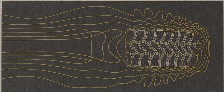
Reconstitué en laboratoire, le débit d'évacuation de l'eau dans le MX: tout a été calculé et testé pour évacuer jusqu'à 25 litres d'eau par seconde et par pneu.
