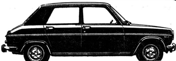
Traction avant - ensemble moteur/botte/pont transversal - 53 CV/DIN (134 km/h) ou 56 CV/DIN (140 km/h) - boîte à 4 vitesses synchronisées (système Porsche) - freins à disque à l'avant - 5 places - 2 ou 4 portes - grande porte à l'arrière - coffre géant - grand confort intérieur - remarquables qualités de routière. Sur demande: boîte semi-automatique. Livrable en version: Berline ou Break. Dès Fr. 7490.-
