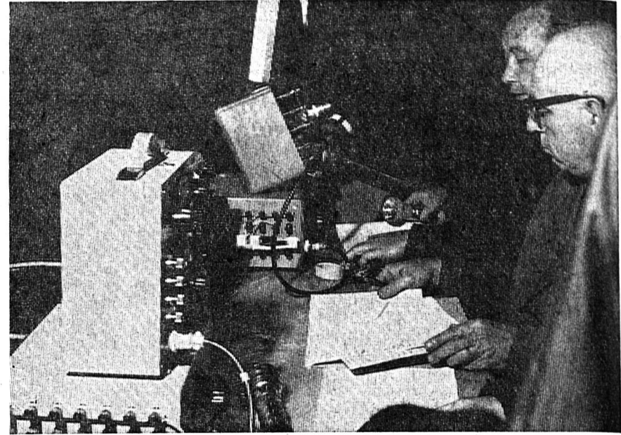
La nuit dernière des ingénieurs ont installé leurs appareils sur le pont du Mont-Blanc à Genève et ont durant toute la nuit observé et calculé les résistances des nouveaux trottoirs. — Notre photo : voici les observateurs, chaudement vêtus, observant les trottoirs qui tremblent.
