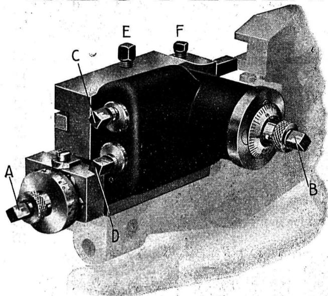
Tous les porte-outils de nos machines sont pourvus du **réglage micrométrique à double contrôle.**
