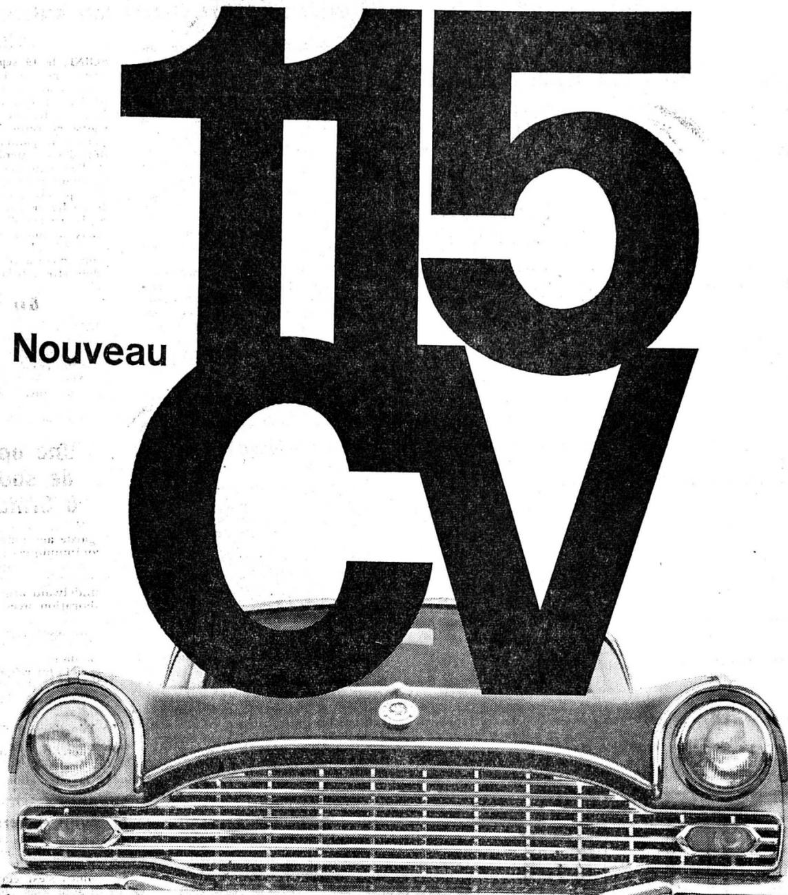
La nouveauté de la nouvelle Cresta: 31 CV en plus! Sa cylindrée passe de 2,3 litres à 2,6 litres. D'où forte augmentation de puissance: 115 CV aux freins au lieu de 84, pour 13,5 CV impôts seulement. Le rapport poids/puissance n'est que de 10,8 kg/CV. La consommation d'essence, par contre, reste la même qu'auparavant. Cette puissance en plus, la Cresta vous l'offre donc gratuitement...
