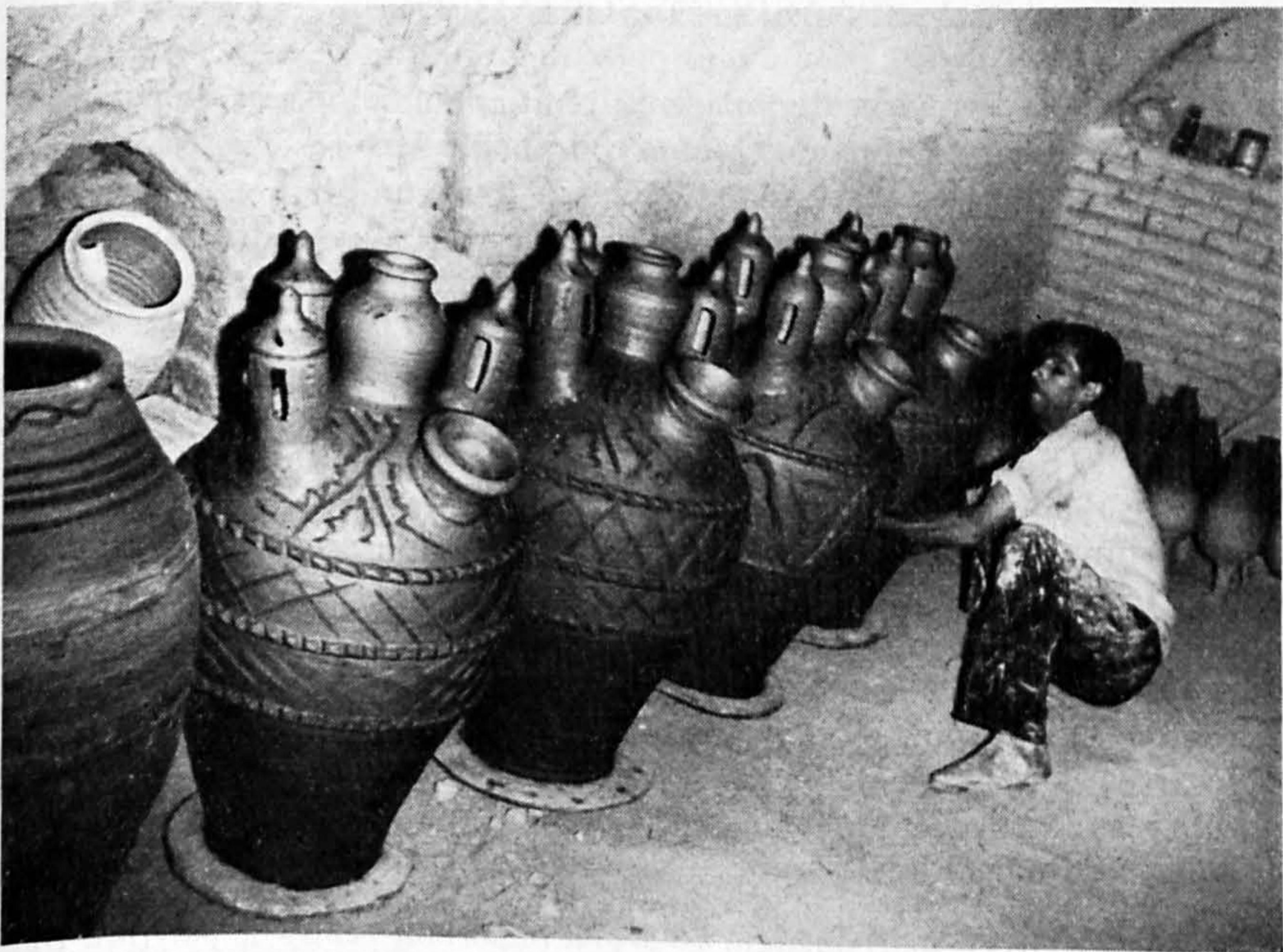
Local de séchage chez Ostâd Mirzâ, qui est le seul potier à savoir façonner ces extraordinaires âbambar ou saqâxâneh (fontaines publiques) d'une contenance de 120 l. Elles sont surmontées de tourelles de ventilation bâdgir et d'un orifice pour le remplissage âbris . A 7 cm de la base, un trou permet d'ajuster un robinet.
