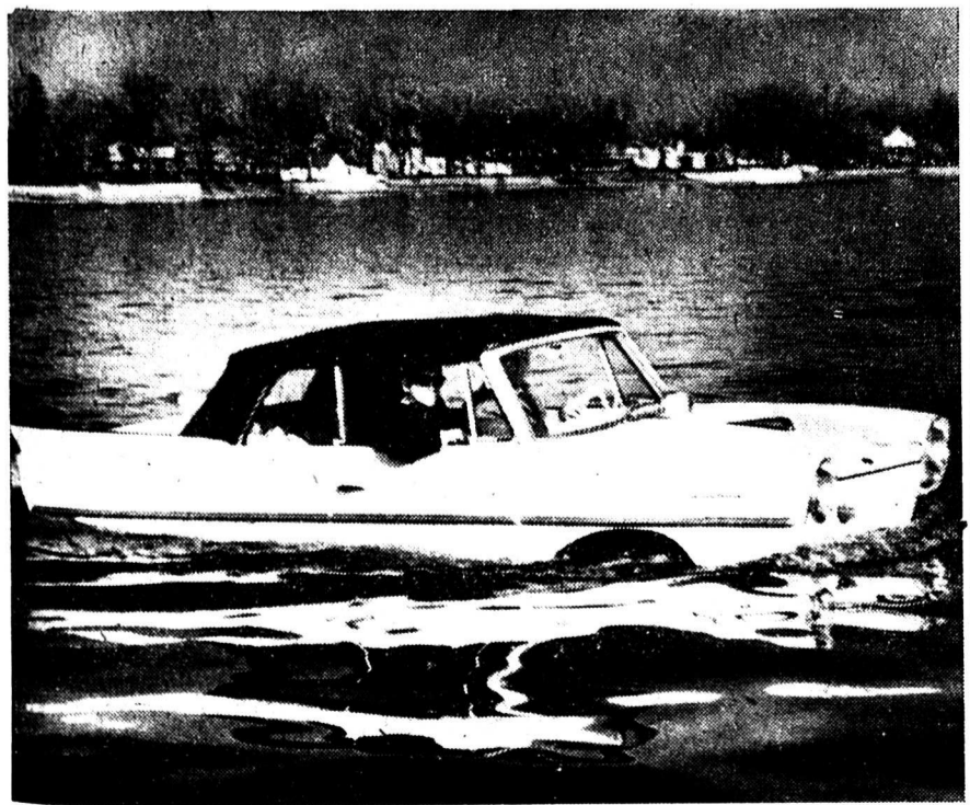
«Amphicar», une voiture amphibie construite en Allemagne a fait ses preuves au Canada, où fut faite cette photo. Le véhicule atteint la vitesse de 16 km/h sur l'eau et de 140 km/h sur la route.
