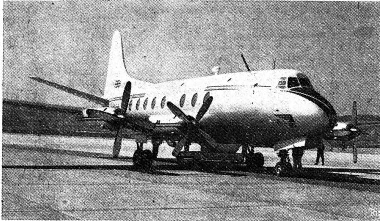
Une compagnie aérienne britannique mettra en service ce printemps pour son trafic avec la Suisse, un nouvel appareil mû par 4 turbines à hélices. Avec une charge de 47 passagers, il atteindra une vitesse de croisière de 500 km. heure. Grâce aux turbines, l'avion ne ressent aucune vibration et vole presque sans bruit.
