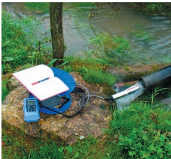
Fig. 5.5: Mesure des paramètres physico-chimiques de l'eau de la source Ledermann (Q34) à l'aide du "Horiba Water Quality Monitor"
