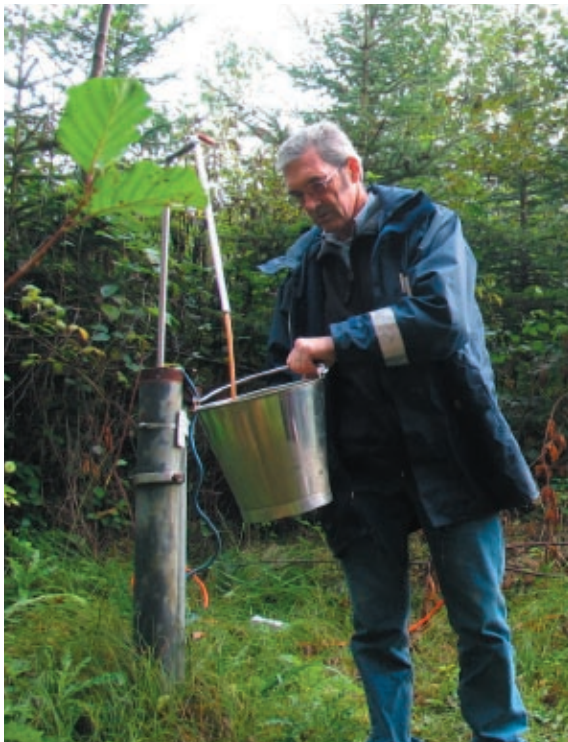
Fig. 7.2: Purgage et mesure du débit du forage SG13
