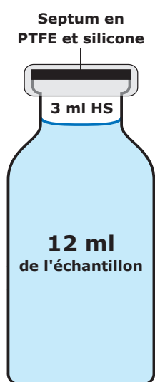
Fig. 5.17: Schéma d'un flacon "headspace"
