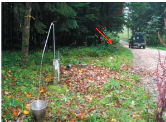
Fig. 5.1: Forage SG36 au sud-est de la décharge, la génératrice à essence est éloigné du forage pour ne pas contaminer l'eau par les gaz d'échappement
