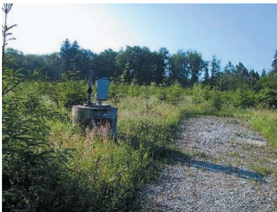
Fig. 1.1: Vue sur la décharge industrielle de Bonfol avec un piézomètre de surveillance, photo OEPN (OEPN, 2004)
