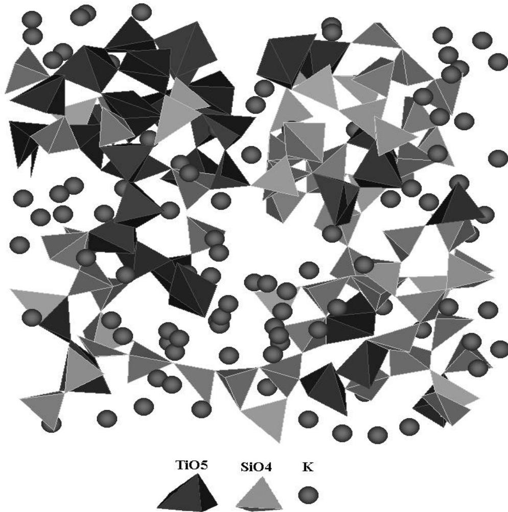
Modèle atomique obtenu par Monte Carlo Inverse sur des données de diffusion des neutrons avec substitution isotopique du verre  $K_2O \cdot TiO_2 \cdot 2SiO_2$
