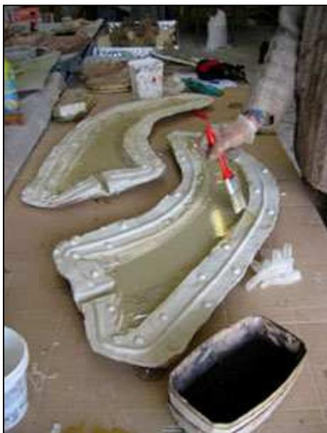
Pour la corne, un fond de résine est coulé dans chaque moitié de moule. Lorsque la résine commence à durcir, on la monte sur les bords à l'aide d'un pinceau pour que toute la surface de la corne soit couverte.
