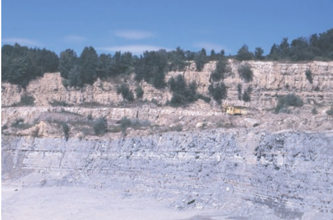
Abbildung 4.10: Übersichtsfoto des Steinbruchs am Rebberg bei Altkirch. Standort; Brecher, Blickrichtung NW. Im unteren Teil sind die grauen Mergel und die Versteinerungsreiche Zone der Mittleren Salzfolge aufgeschlossen. Darüber lagern die basalen Kalkarenite des Hausteins (links vom Bagger). Darüber folgen die Mergel, Kalke und Kalksandsteine des Hausteins.
