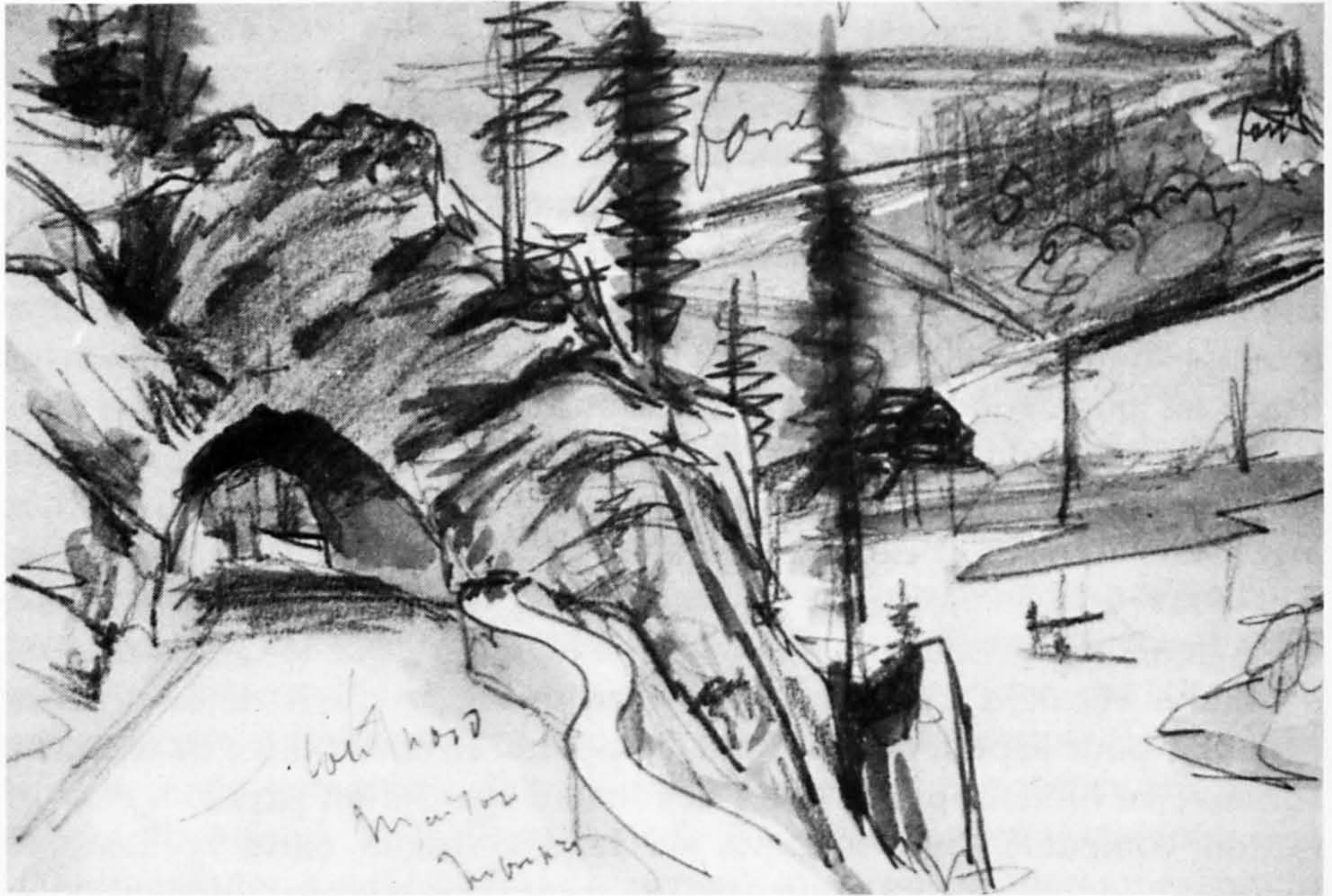
Louis Guillaume. Croquis d'un tunnel proche de la Maison-Monsieur et de l'emplacement choisi pour le pont de Biaufond. Le dessinateur a noté la nature du terrain (forêt, prairie, éboulis) et les points d'accrochage du pont.
