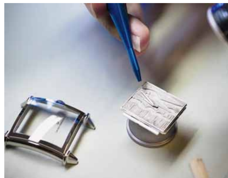
Le cadran en béton nécessite trois jours de travail. SP-PATRICE SCHREYER
