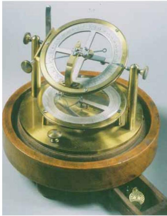
Balancier servant à mesurer l'isochronisme des ressorts spiraux. SP
