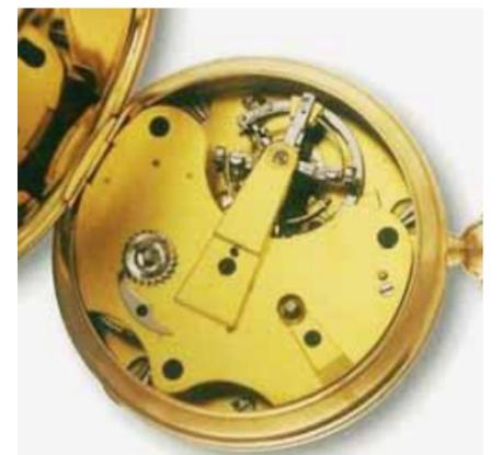
Chronomètre de poche à tourbillon en or avec thermomètre, produit par Houriet vers 1828. SP
