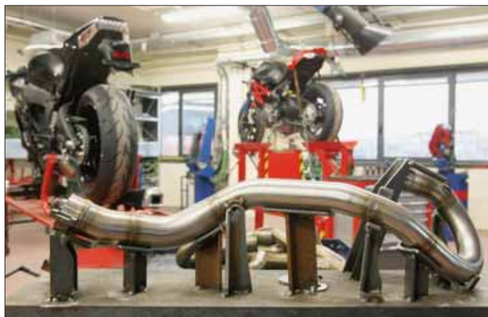
POT D'ÉCHAPPEMENT TERMIGNONI C'est à partir de 4 ou 5 prototypes aux formes différentes que la version définitive sera créée manuellement en fonction des particularités de la moto. (SP)
