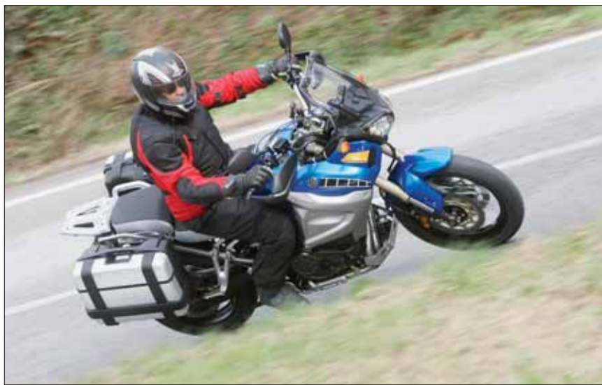
YAMAHA SUPER TÉNÉRÉ 1200 Le bicylindre qui développe 110 CV, comprend une double cartographie du réglage du moteur en mode sport ou tourisme. (SP)
