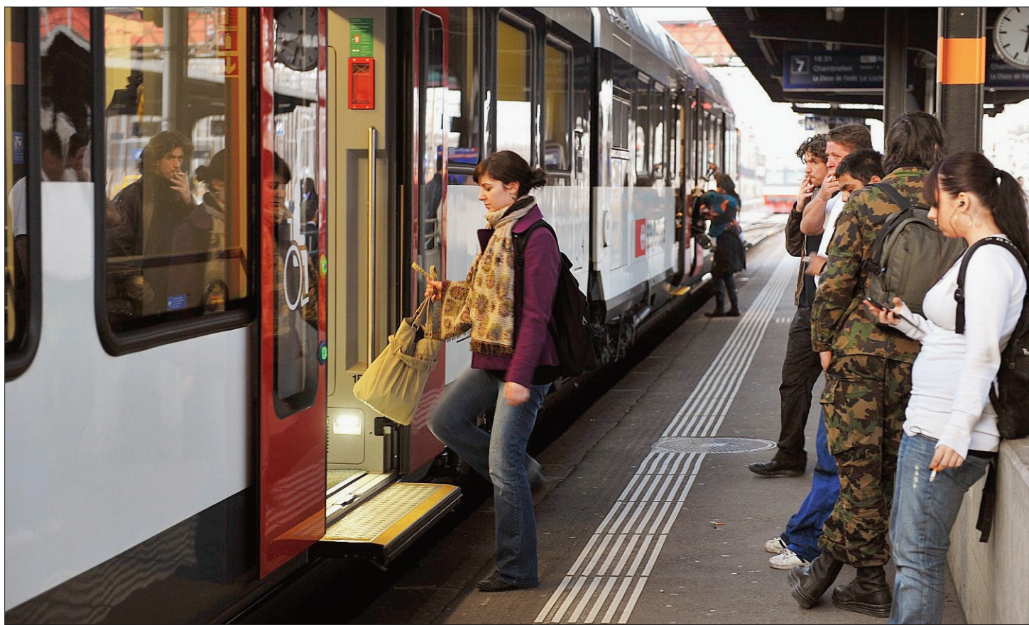
DOMINO Lorsque le quai est surélevé – ce qui n'est pas le cas à Neuchâtel sur la voie 7 montrée ci-dessus – la voiture intermédiaire permet à une personne en chaise d'accéder au train sans aide.
