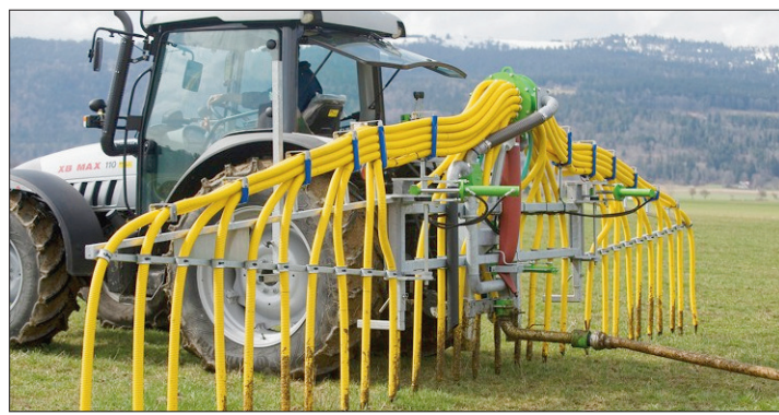
MOINS DE FUITES DANS L'AIR Le pendillard (alimenté dans ce cas par une conduite reliée à la fosse à purin et non par une citerne tirée par le tracteur) permet au lisier de s'écouler directement dans le sol. (DAVID MARCHON)
