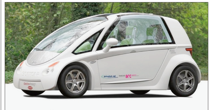
UPGO Cette citadine ultralégère pèse 460 kilos avec les batteries. La HE-Arc ingénierie a réalisé l'optimisation du châssis en aluminium. (SP)
