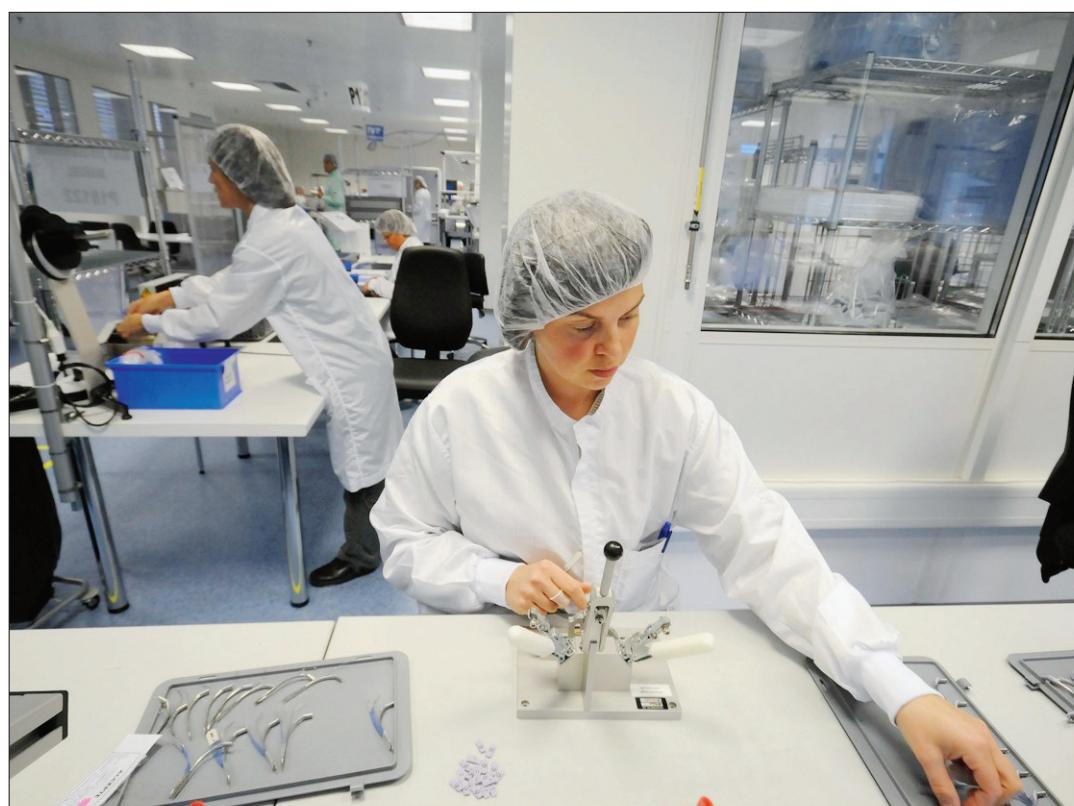
**FABRICATION** C'est en salle blanche, dans des locaux sous atmosphère contrôlée, que sont assemblés les implants Gynecare TTV.
