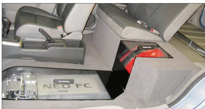
NISSAN La pile à combustible et le réservoir à hydrogène sont logés sous les sièges de l'X-Trail, qui a perdu sa transmission arrière dans l'opération. (SP)
