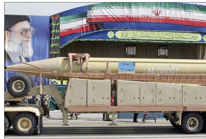
SHAHAB 3 Un missile d'une portée de 2000 kilomètres, capable d'emporter une charge utile d'une tonne. (KEYSTONE)
