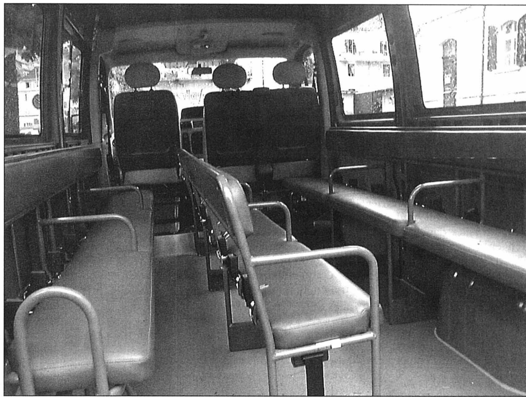
Le bus acheté par la commune du Locle l'été dernier est équipé de bancs longitudinaux munis de ceintures. PHOTO ARCH-PERRIN
