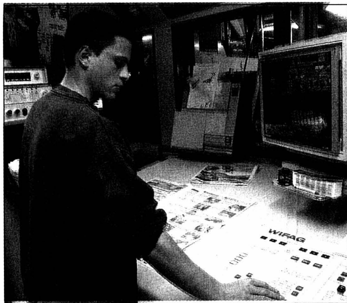
Encrage, vitesse, tension... L'impression est surveillée et corrigée électroniquement.
