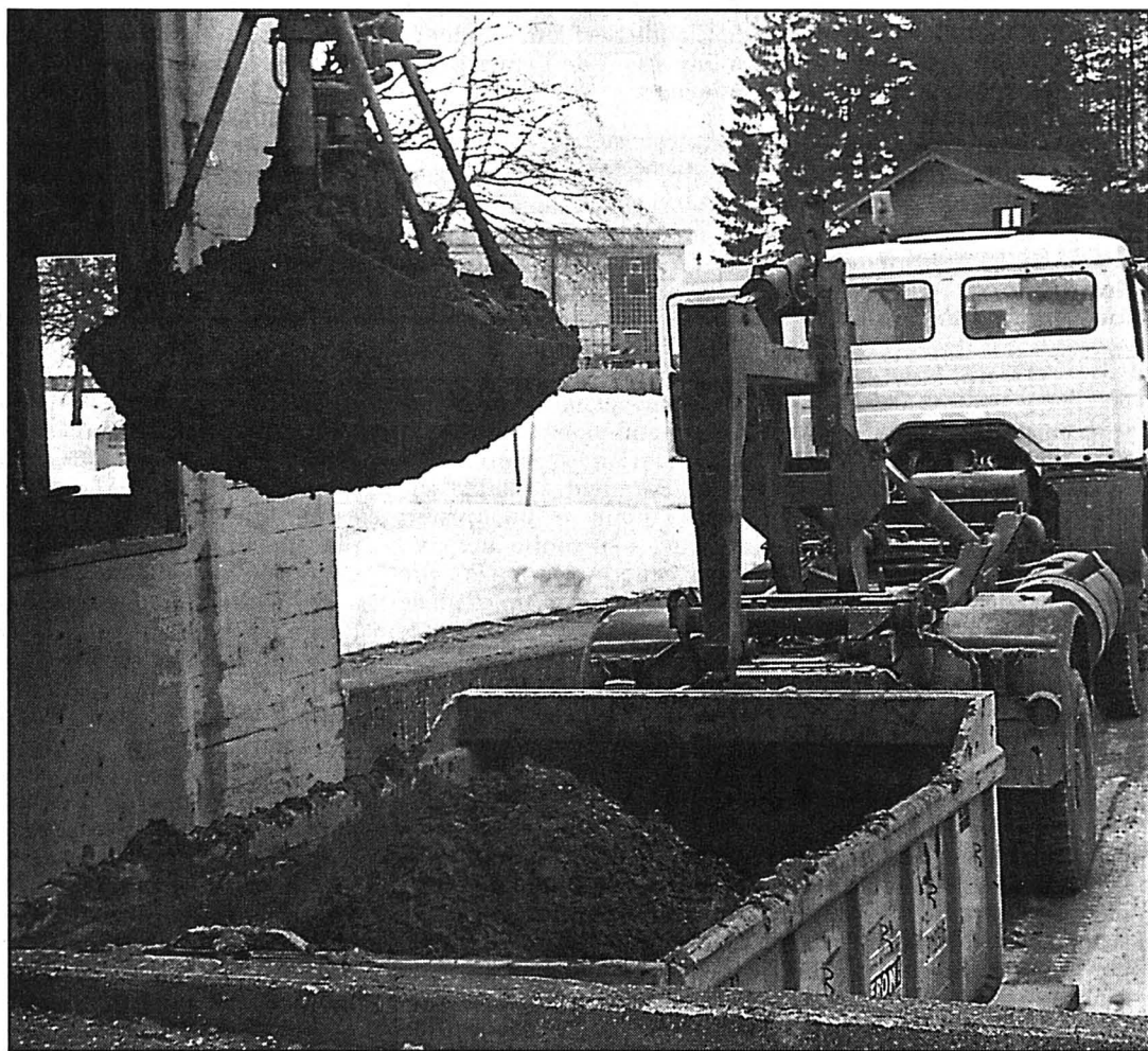
Les boues rejetées par la station d'épuration. Leur élimination est coûteuse.
