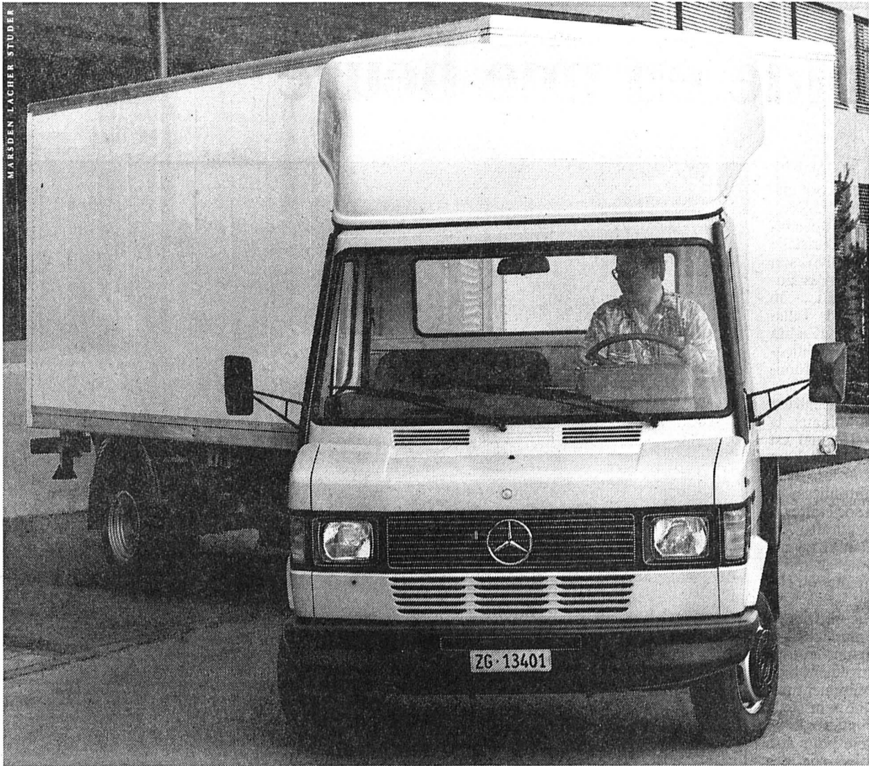
Le semi-remorque 410 DS, avec moteur diesel de 70 kW (95 ch) optimisé au niveau des gaz d'échappement, offre un poids total de charge de 6,6 t.
