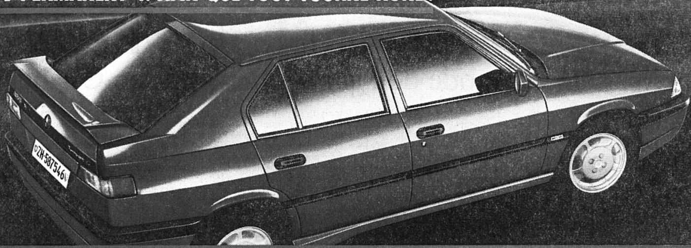
Route sèche ou humide: avec la traction intégrale permanente, vous êtes toujours en sécurité. Le visco-coupleur répartit automatiquement la force de traction du moteur dans un rapport équilibré entre les roues avant et arrière. Ainsi, dès que les roues avant patinent, une force de traction
