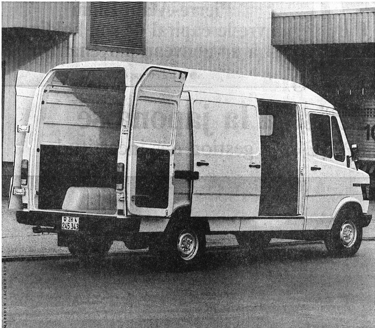
Les fourgons Mercedes, dotés d'ouvertures de portières adaptées aux palettes et de parois latérales verticales, ne connaissent aucune entrave au chargement.
