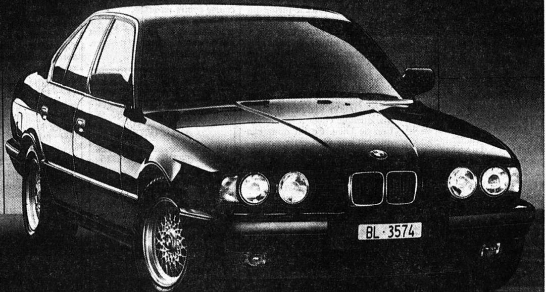
Avec son moteur 3,5l, six cylindres en ligne, développant 211 ch, la BMW 535i bénéficie désormais du système électronique ASC en série (Contrôle automatique de stabilité). Il permet d'éviter le patinage des roues motrices d'où une maîtrise accrue du véhicule. (Pour des impératifs techniques, non valide pour les contrats d'achat déjà conclus.)
