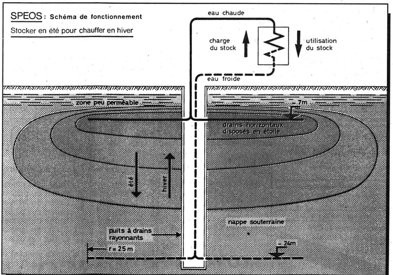
SPEOS: un puits de 30 mètres qui plonge dans la nappe phréatique. On pompe de l'eau froide au fond du puits l'été pour la chauffer avec le surplus d'énergie et la stocker à faible profondeur. Le processus est inversé en hiver.
