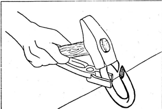
Lorsqu'il désire souder des anneaux, au feu, le forgeron superpose les languettes coniques préalablement forgées et il introduit une plaquette à souder.
