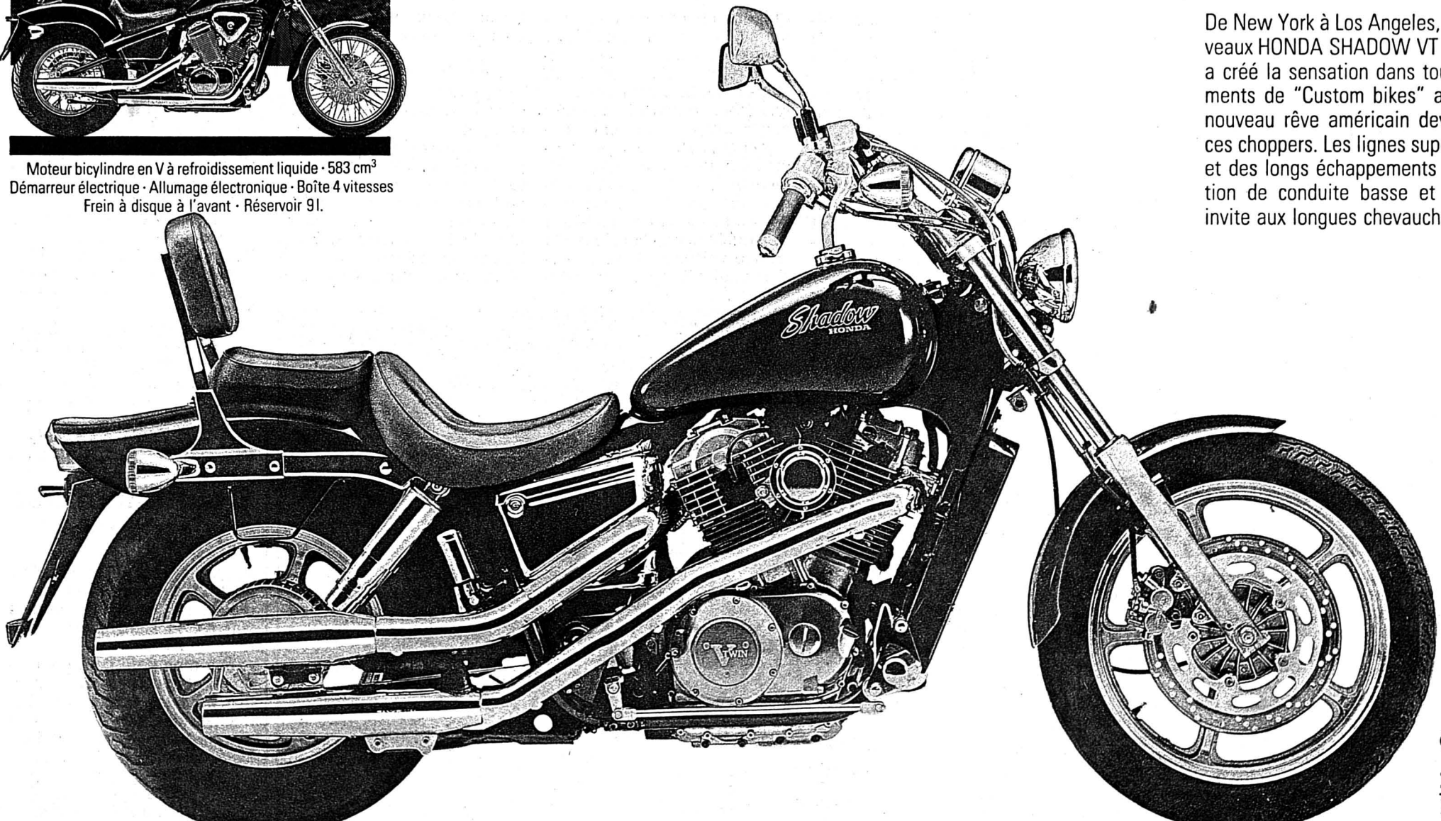
Moteur bicylindre en V à refroidissement liquide - 1086 cm 3 - Démarreur électrique - Allumage électronique - Boîte 4 vitesses Frein à disque à l'avant - Réservoir 13l.
