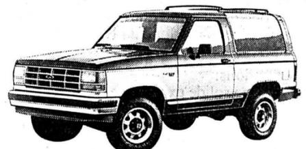
**Ford Bronco 4x4.** **Moteur:** 2.9i V6 (boîte automatique). **Puissance:** 105 kW/142 ch. **De série:** ABS, climatisation, lève-glaces électriques, radio-cassette, jantes alu, traction intégrale enclenchable électriquement. **Prix:** 39 900.-.
