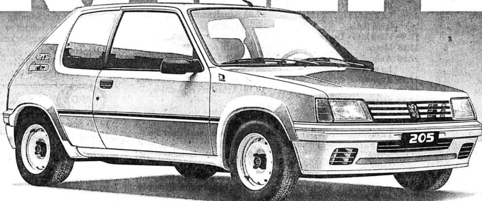
Toute blanche, avec d'élégantes décorations de couleur, voici la nouvelle 205 Rallye. 1905 cm<sup>3</sup>, injection électronique et 105 chevaux pour une conduite sportive: 0 à 100 km/h en 9,5 sec., 190 km/h chrono. Traction avant, suspension indépendante sur les quatre roues et freins à disque ventilés à l'avant pour la sécurité et le plaisir au volant. Quant à l'équipement, il est plus que complet. Il comprend entre
